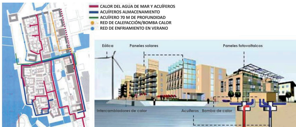
Figura 3.4.24.: Los sistemas de ahorro energético están vinculados a nuevas tecnologías limpias y a las condiciones que ofrece de manera renovable su medio natural. Dirección de Medio Ambiente de la ciudad de Malmö.
