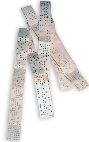
| 32 | Cinta impresa con el traductor Baudot. Cinta impresa amb el traductor Baudot.
