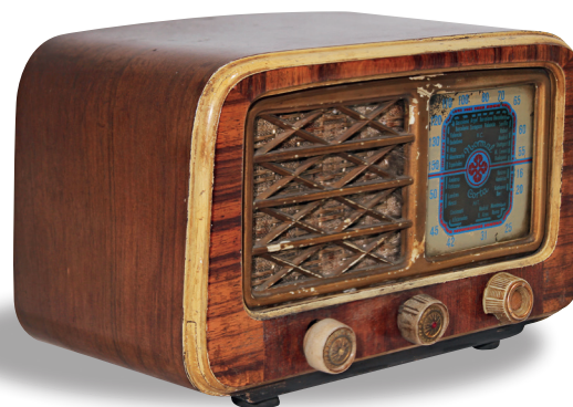
| 64 | Radio Funcional. S. XX, años 40. Receptor de construcción artesanal con circuito de 5 válvulas. Como otros receptores de la época, solía llevar un elevador-reductor de tensión con voltímetro, conectado a la red eléctrica, para funcionar. Ràdio Funcional. S. XX, anys quaranta. Receptor de construcció artesanal amb circuit de 5 vàlvules. Com altres receptors similars, requereix un transformador connectat a la xarxa elèctrica per a funcionar.
