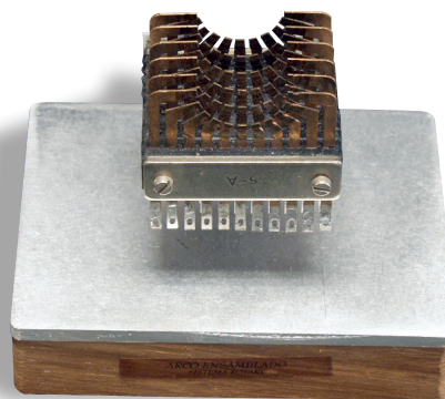
[34] Arco ensamblado de sistema Rotary (réplica). S.XX, años 30. Arc assemblat de sistema Rotary (rèplica). Segle XX, anys trenta.
