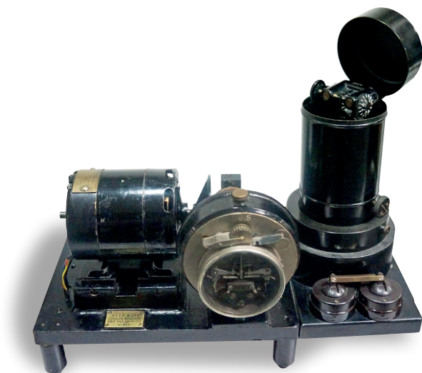
| 20 | Sistema Morse Creed, transmisor automático. S. XX, años 30. Traductor Morse Creed, transmissor automàtic. S. XX, anys trenta.
