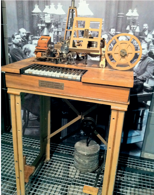
| 26 | Aparato telegráfico de impresión directa Hughes. Aparell telegràfic d'impressió directa Hughes.
