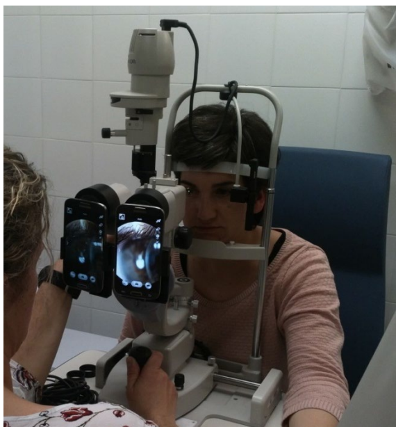
Fig. 2 Lámpara de hendidura donde en el sistema de observación se han acoplado dos móviles uno en cada ocular para la toma de imágenes sencillas.
