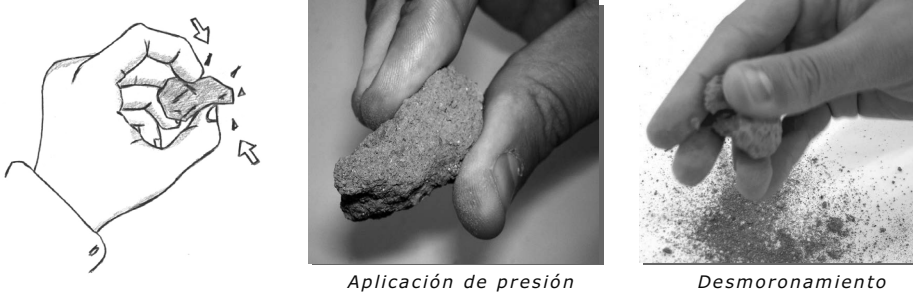
Fig.1.9: Ejemplo de determinación de resistencia en seco.
