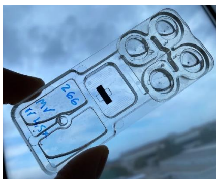
Figura 2. Cartucho microflúidico que contienen el biosensor
