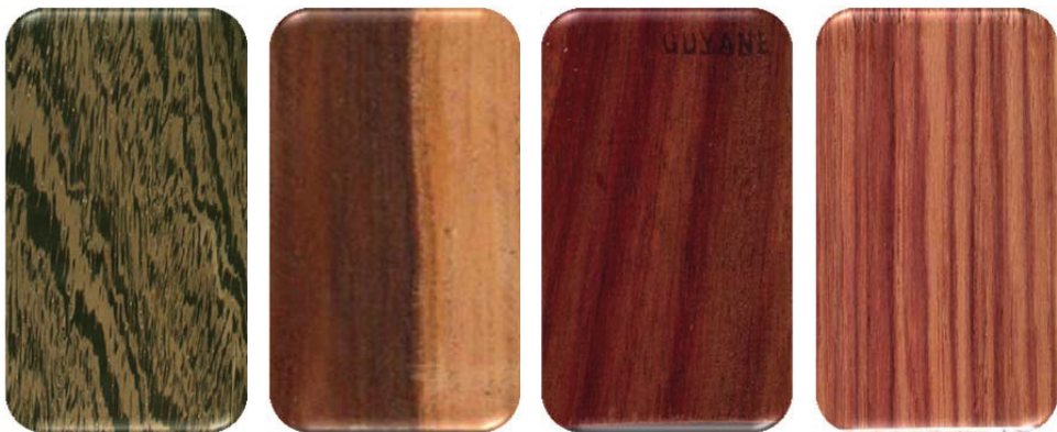
Imagen 3. De izquierda a derecha: madera de wengue cortada al sesgo, de guayacán cortada radialmente exponiendo albura y duramen, de satín rojo cortada longitudinalmente con ángulo de inclinación y de tulipán cortada radialmente para garantizar el dibujo y veteados
