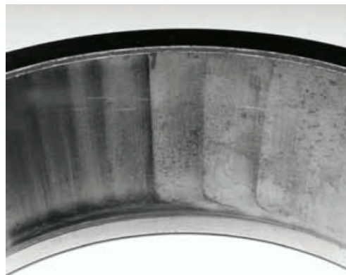
Figura 1.23. Marcas en pista de rodamiento de rodillos cónicos causadas por un juego excesivo. Fuente: fotografía cortesía de la compañía Timken
