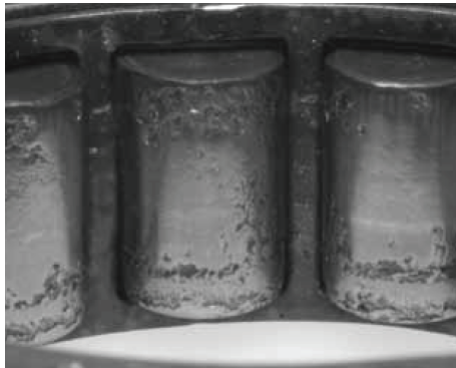
Figura 1.36. Desconchado en rodamiento de rodillos cilíndricos por carga excesiva. Fuente: fotografía cortesía de la compañía Timken
