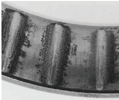
Figura 1.38. Desgaste por fretting (sin girar) en pista externa de rodamiento de rodillos cónicos.
