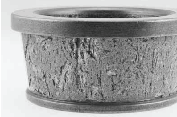
Figura 1.35. Desconchado en rodamiento de rodillos cónicos por carga alta con baja velocidad y mala lubricación. Fuente: fotografía cortesía de la compañía Timken
