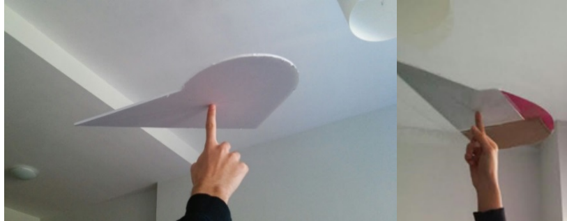
Figura 4: Piezas homogénea y heterogénea con CM indicado por el dedo.
