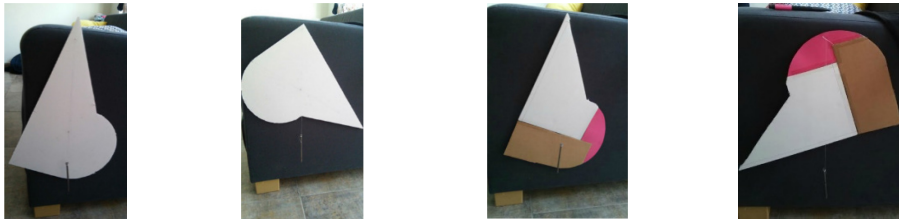
Figura 3: Pieza homogénea y heterogénea colgada de dos puntos diferentes y sus plomadas.
