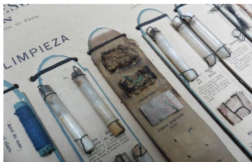
Fig. 6. Tinción del soporte por la disolución de muestras de jabones.
