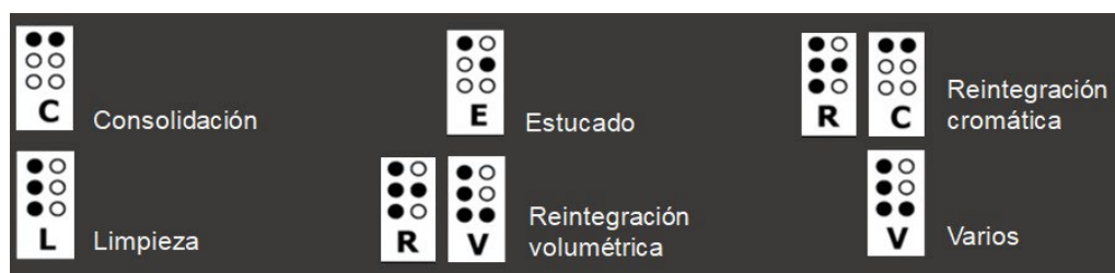
Fig. 5. Leyendas táctiles adaptadas para invidentes aplicando códigos en braille en las zonas restauradas
