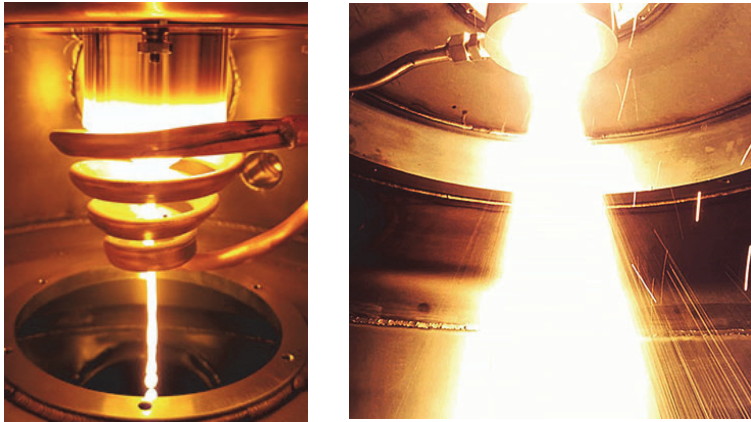
Figura 33. Atomizador por gas (adaptado de Arcast Inc.)
