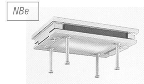
Apoyo de neopreno zunchado simple (NB), anclado (NBa) y fijo en una dirección (NBe), nomenclatura de la firma PROCEQ
