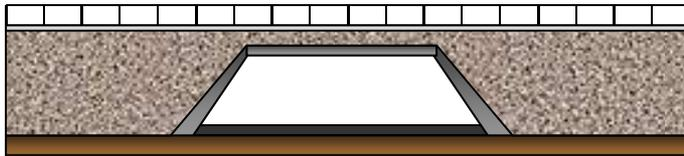
*Estructura trapezoidal que resuelve correctamente el diseño del paso inferior cuando la luz es corta*
