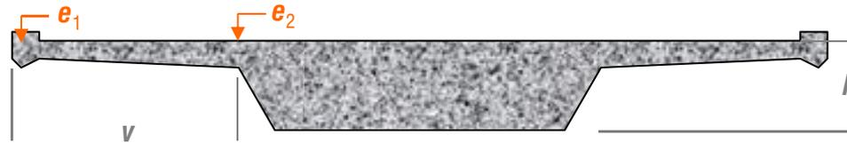
(d) *Losas aligeradas de alas anchas*: canto  $h \leq 1.40 \text{ m}$ ,  $l_0 \leq 35 \text{ m}$
