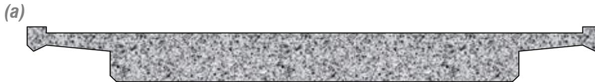
❑ **Problema resistente**: al presentar una distribución uniforme de rigidez a flexión, la losa maciza (a) constituye la solución estructural **menos eficiente** para el diseño de la sección transversal de un puente (omite las direcciones principales de flexión inducidas por la posición en planta de los apoyos)
