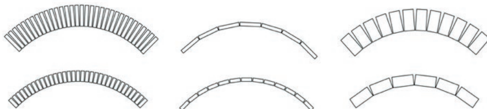
Figura 8. Posibles posiciones del ladrillo en un arco. De izquierda a derecha, a rosca, tabicado, por hojas.
